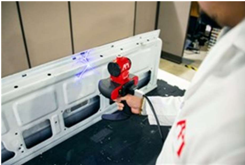
API iScan3D in der Anwendung. Ergonomie des iScan3D für das Scannen und taktile Messungen
